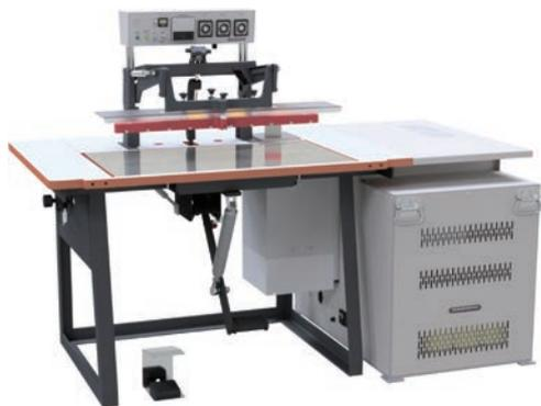
足踏みで作動するフットペダルモデルの高周波溶着機
