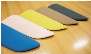
高質感塩ビ合成皮革 カラーサンプル 塩ビ合成皮革は、一般的にポリウレタン合成皮革に比べて安価で提供できるという強みがあります。高質感塩ビ合成皮革 カラーサンプル が、性質としては耐久性と柔軟性の面で劣るという課題がありました。「パートナー」の開発により、塩ビ合成皮革がポリウレタン合成皮革の代替として利用可能な範囲を広げています。「自動車メーカーの方々に『パートナー』を見ていただくと、塩ビ合成皮革でもポリウレタン合成皮革に遜色ない高級感のある質感が出せることに驚かれる方も多かったです」(山下氏)
