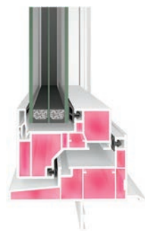
EWシリーズの断面。窓枠・框の内部を小さな部屋に分ける「多層ホロー構造」で作られている。
