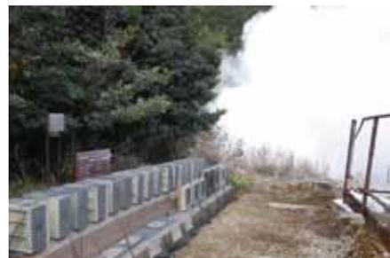
霧島曝露場での試験風景。傍らの地中からは絶え間なく火山性ガスが噴出している。
