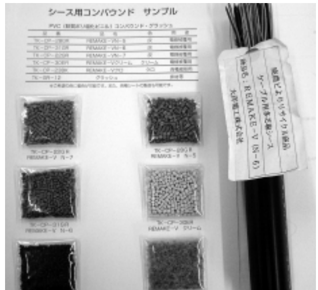
大洋電工のペレットと電線被覆材
