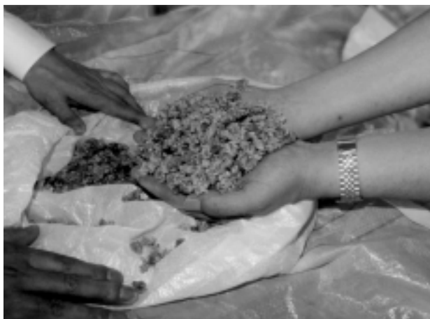
ペレット状に固形化された再生原料
