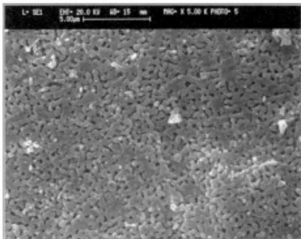
反応剤の活性の変化(上は温度変化前の滑らかな粒子表面。下は温度変化後の特殊な多孔質の表面)
