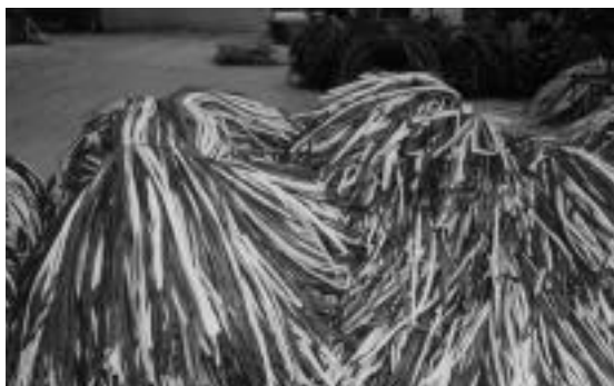
剥離解体された塩ビ被覆材
