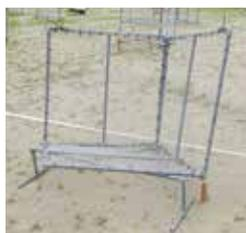
これが電波反射器。塩ビ管と継手で組み立てたフレームに金網を張り、バンドで固定している。折りたたむことも可能。
