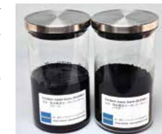
▲ カーボンナノホーンの粉末。カーボンナノホーンとは、ナノカーボン（直径がナノメートル〈10億分の1メートル〉単位の炭素粒子で構成される物質）の一種。導電性や耐熱性、機械的強度にすぐれ、水溶性が高い。
