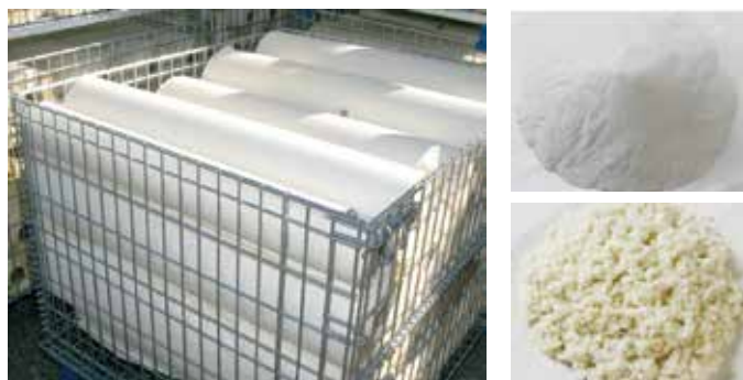
塩ビ壁紙の工場端材（左）が塩ビコンパウンド（右上）とパルプ粉に生まれ変わる
