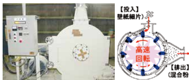
叩解装置の外観（左）と、内部の構造
