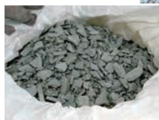
リサイクル工場に持ち込まれた使用済み塩ビ管。1次2次破碎を経て、再生原料に生まれ変わる（左の写真）
