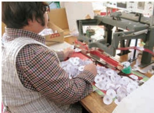
ビーチボールは、通常6枚のパーツを貼り合わせて作られるが、8枚、10枚とパーツを増やしていくほど完璧な球形になる。左の写真は、高周波ウェルダでパーツを溶着しているところ。右はビニールの空気栓を溶着しているところ。いずれも熟練の技が求められる。
