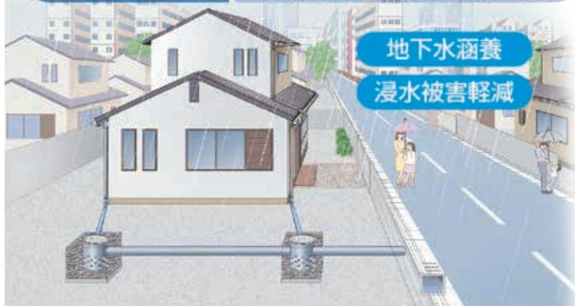
硬質塩化ビニル製雨水浸透ます
