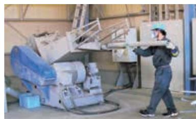
長尺管専用の破砕機も導入
